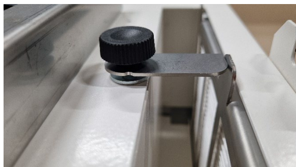
Klem de filterhouder met het klemplaatje vast naar beneden toe
